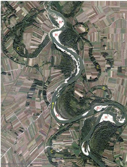
2. Деформација речног корита: рушење обале реке Ресаве (горе) и промена трасе Велике Мораве са (C) напуштеним деловима корита и (H) депонијама наноса (доле).
