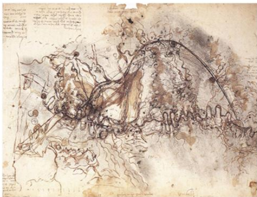
1. Уређење реке Арно са ободним каналом за заштиту од поплава и пловидбу, цртеж Леонарда да Винчија, 1503.
