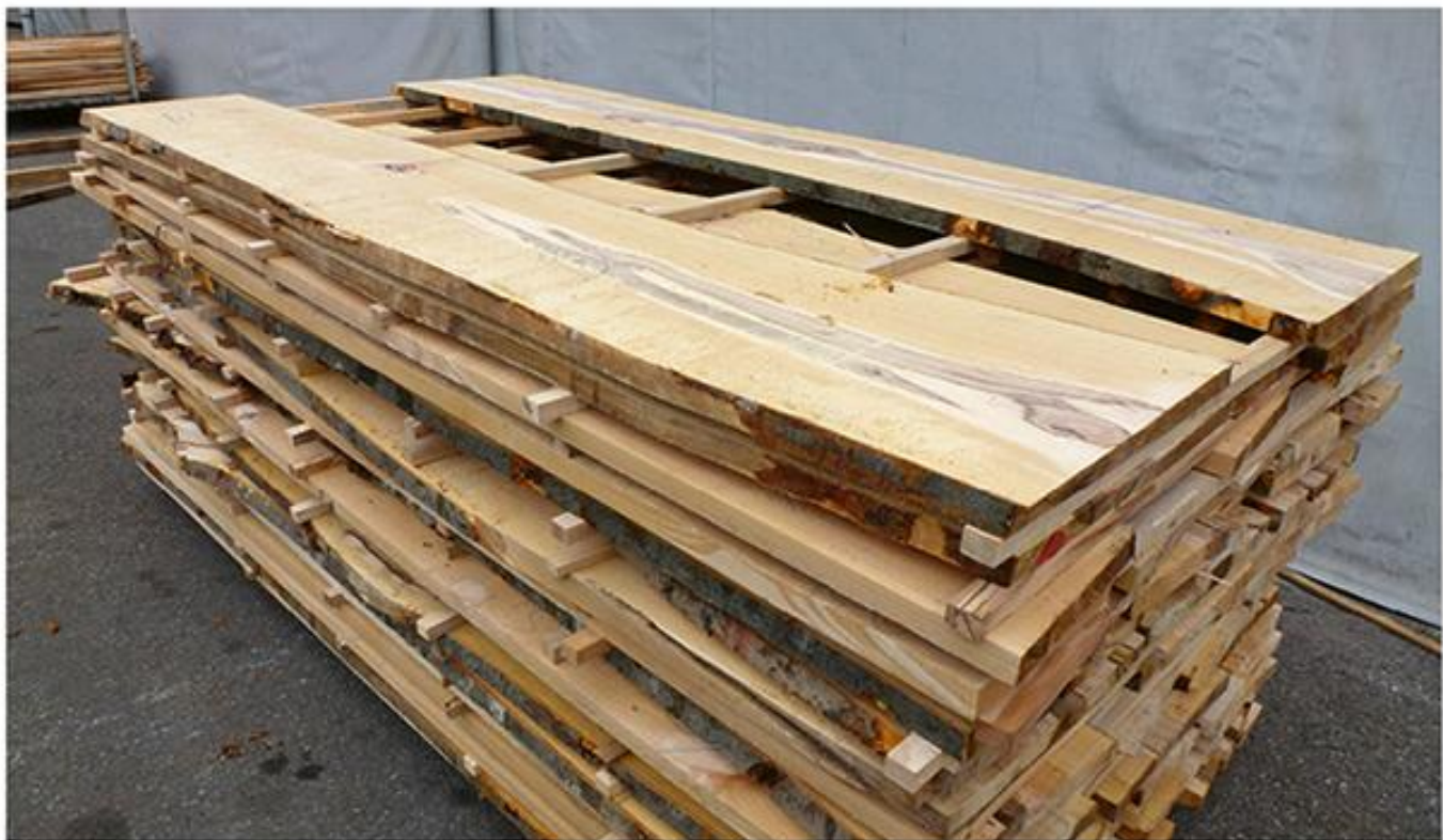
Изглед сложаја резане грађе букве која се припрема за природно просушивање, а затим за вештачко сушење у сушарама за дрво
