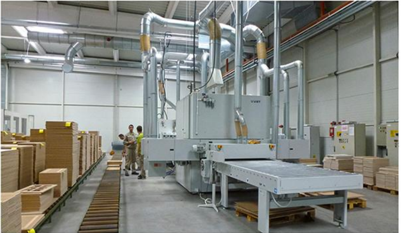
Савремена линија за површинску обраду (лакирање) у фабрици плочастог намештаја
