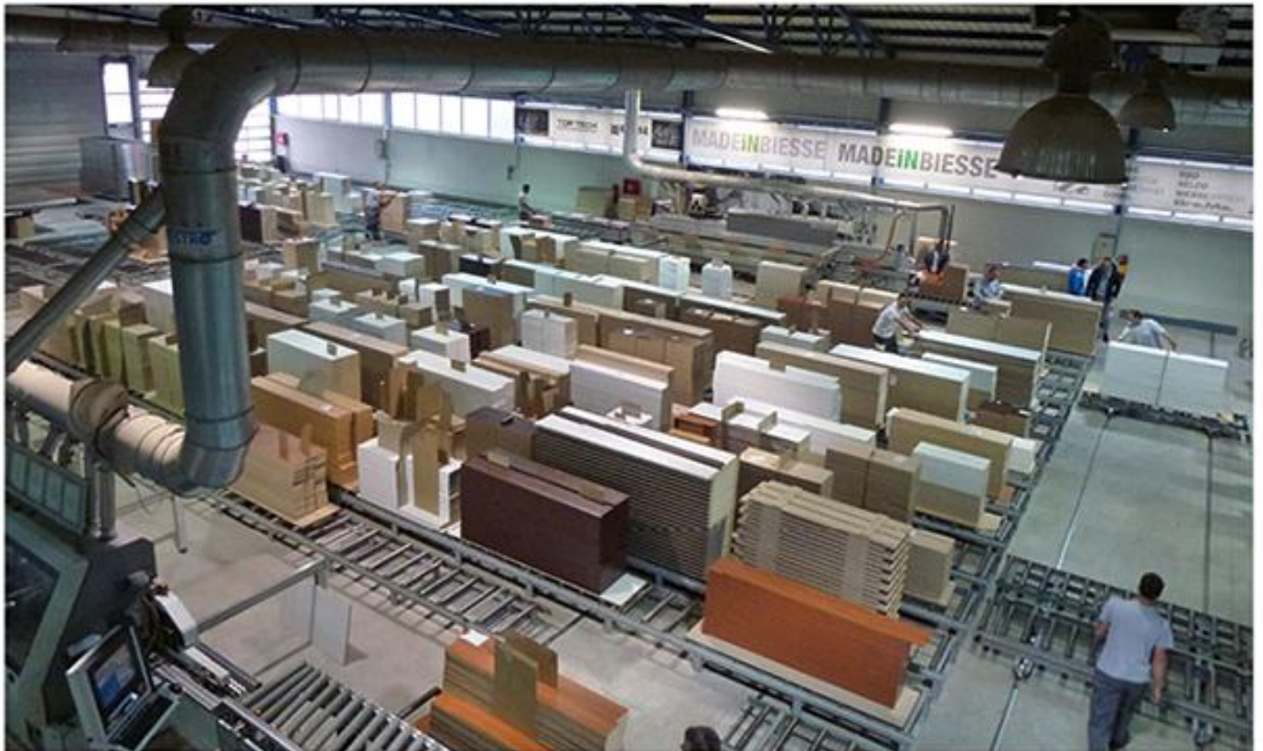
Изглед погона за кројење плоча са међуфазним складиштем у фабрици намештаја
