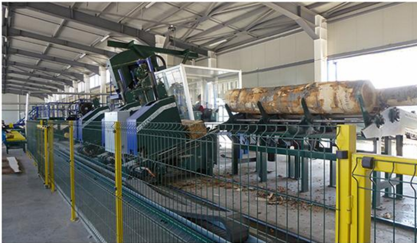
Савремена линија у пилани за производњу резане грађе са високим нивоом аутоматизације процеса и оптимизације резања трупца
