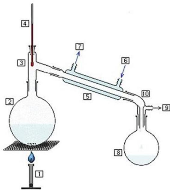
Легенда: 1. извор топлоте; 2. дестилациони балон са смесом течности коју треба раставити; 3. наставак за термометар; 4. термометар за контролисање температуре паре; 5. хладњак у којем се кондензује пара дестиловане течности; 6. и 7. улаз/излаз воде за хлађење; 8. суд за прихватање течности настале кондензацијом паре; 9. отвор за изједначавање притиска или за прикључивање других уређаја на 10. предложак (лула).
